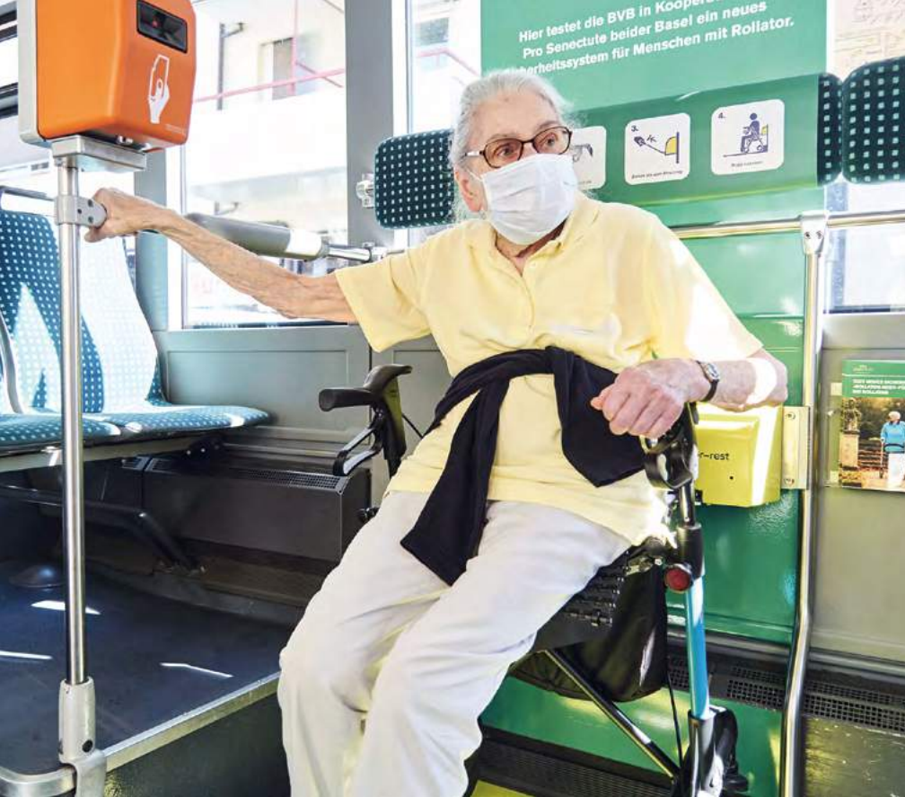
Das neue System fixiert den Rollator, sodass er sogar als Sitzplatz dient.
